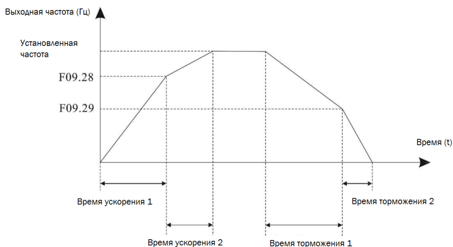
Рисунок 6-16 – Переключение между t ускорения 1 и 2 / торможения 1 и 2
