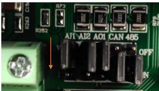
Рисунок 2. Установка перемычки входа AI1
